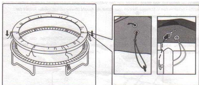
Plasa de siguranta se monteaza pe stalpi inainte ca acestia sa fie montati pe cadru.
